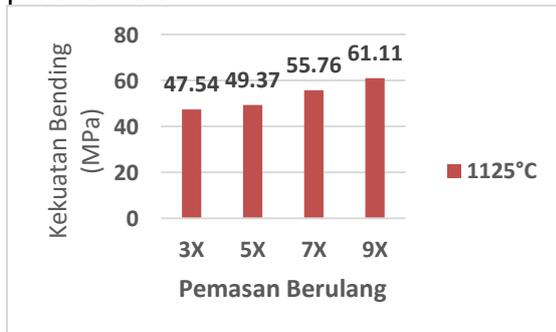
**Gambar 4.10.** Pengaruh pemanasan berulang terhadap kekuatan bending komposit *clay/fly ash* komposisi 50 % fraksi berat *fly ash* dengan temperatur 1125 °C
