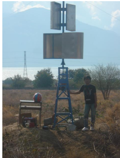
Gambar 5. Hasil perakitan kincir angin savonius dengan rotor 2 tingkat
