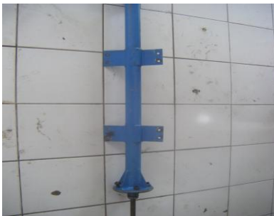
Gambar 2. Poros vertikal kincir angin
