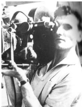
fig. 19 uma Éclair Cameflex, com o chassi apoiado no ombro do operador, na filmagem de Acosado . Note o visor na parte superior da câmera (fonte: ETTEGUI, Peter. Cinematography screencraft . Boston: Focal Press, 1998).
