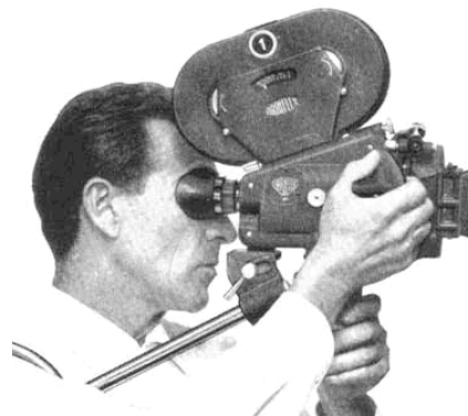
fig. 20: Arriflex II quando em operação de câmera na mão. Neste caso há um suporte de ombro. Note o visor no meio do corpo da câmera (fonte: ARRIFLEX CORP. Arriflex 35 model II C instruction manual . Munique: Arri Hausdruck, 1969).
