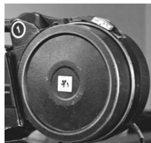
fig. 9: chassi coaxial. Note a espessura, onde um rolo fica ao lado do outro. (fonte: foto do autor).
