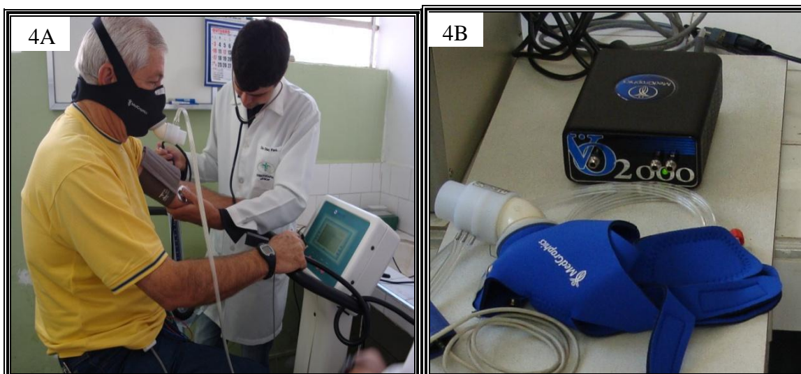
Figuras 4A e 4B: Coleta dos gases com o paciente em repouso e a ilustração do ergoespirômetro (VO 2000 MedGraphics®), máscara e pneumotacógrafo.
