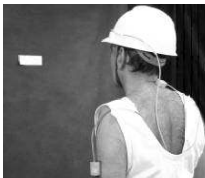
Figura 4. Posição neutra de referência para o registro postural da cabeça e tronco superior.
