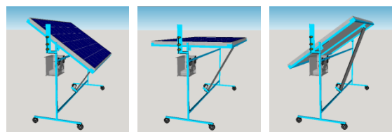
Gambar 3. Perencanaan konstruksi dan posisi panel surya 3 posisi gerakan
