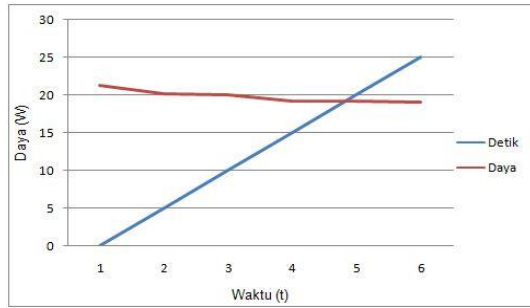
Gambar 19. Kurva daya motor berdasarkan waktu pada gerakan kedua
