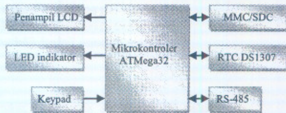
Gbr.2 – Blok perangkat-keras unit master
