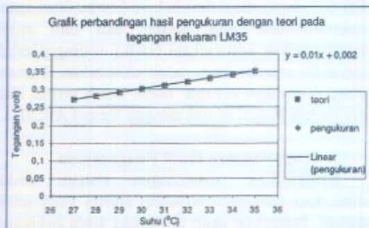
Gbr.5 Grafik perbandingan tegangan keluaran pada LM35
