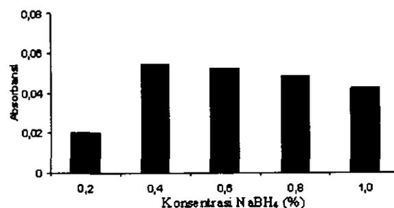
**Gambar 7.** Pengaruh konsentrasi NaBH<sub>4</sub> pada penentuan ion Sn dengan metode HG-QFAAS
