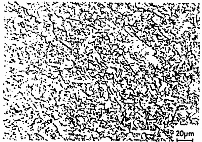
Gambar 6. Struktur mikro sampel SiC campuran 6, setelah HIP pada temperatur 2000^\circ\text{C}
