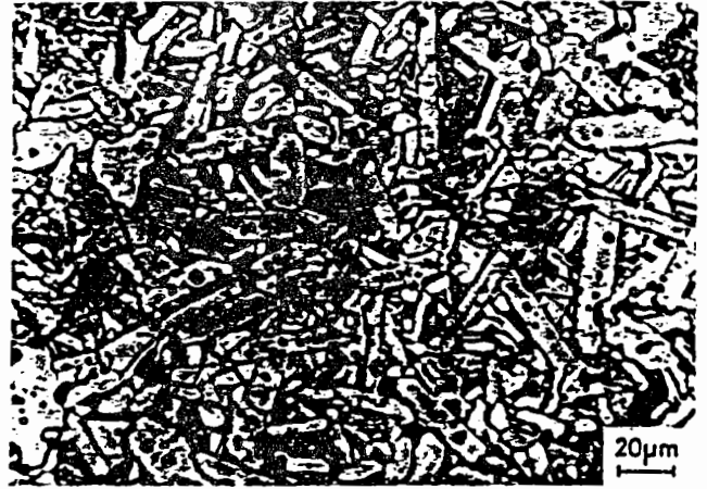
Gambar 2. Struktur mikro sampel SiC campuran 4, disinter pada temperatur 2100°C
