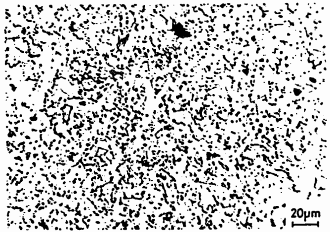
Gambar 5. Struktur mikro sampel SiC campuran 6, disinter pada temperatur 1960^\circ\text{C}
