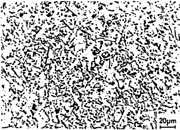
Gambar 3. Struktur mikro sampel SiC campuran 3, disinter pada temperatur 1960^\circ\text{C}
