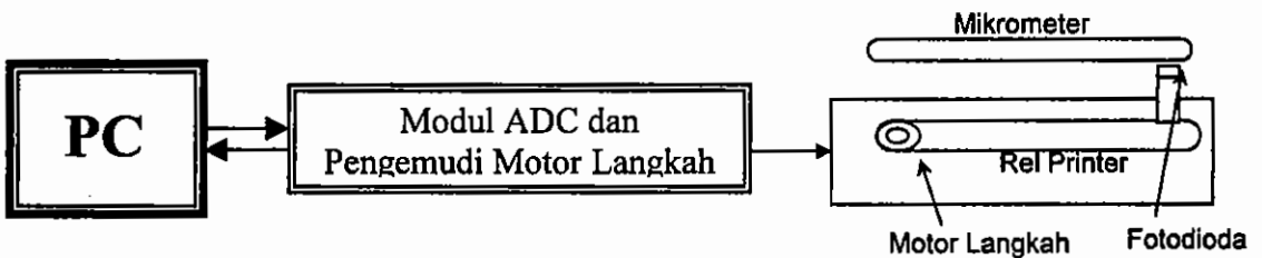
Gambar 4. Skema pengujian linieritas motor langkah
