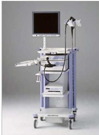
Gambar 2. Seperangkat NBI: monitor, sumber cahaya NBI, prosesor gambar, sumber cahaya konvensional, dan keyboard. 21
