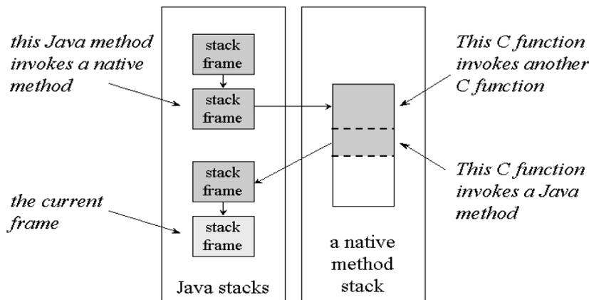
Gambar 3. stack untuk thread yang memanggil Java dan native method
