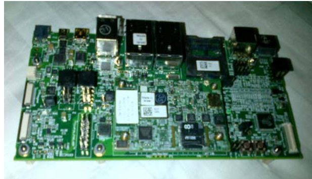
Gambar 3. Modul Microcontroller dan DSP dengan carrier board yang dilengkapi dengan USB, RAM, ROM.
