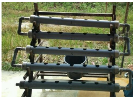
Gambar 5. Rancang bangun nutrient film technique (NFT) untuk Budi Daya Sayuran Hidroponik
