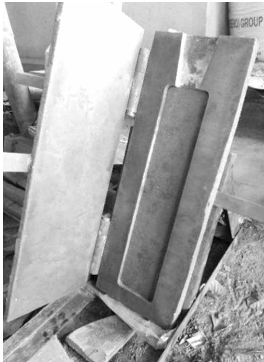
Gambar 6 Cetakan Permanen untuk Bilah Gamelan
