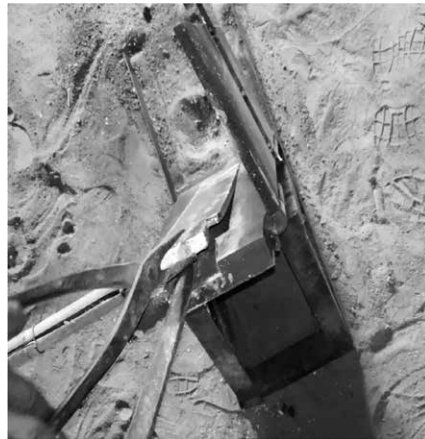
Gambar 15 Proses Pembongkaran Hasil Pengecoran dari Cetakan
