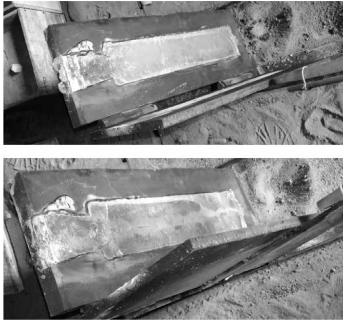
Gambar 14 Proses Pendinginan Hasil Pengecoran
