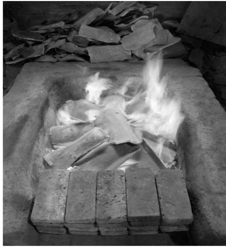
Gambar 12 Proses Peleburan Bahan Baku Kuningan
