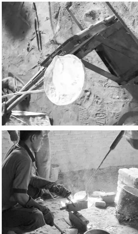
Gambar 13 Penuangan Cairan Logam Kuningan ke dalam Cetakan
