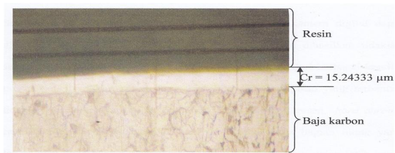
Gambar 4. Lapisan Chrome pada rapat arus 30 A/dm^2
