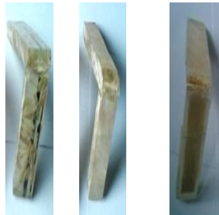
Gambar 5. Foto patahan spesimen uji bending
