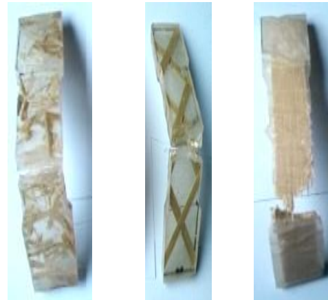
Gambar 4. Foto patahan spesimen uji tarik
