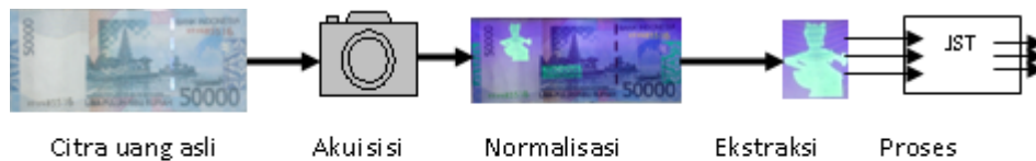
Gambar 2. Proses Sistem Deteksi Uang Palsu
