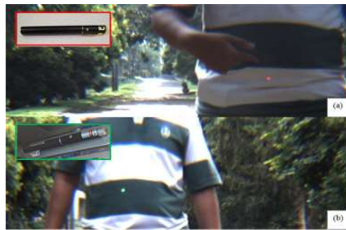
Gambar 1. Pointer laser dari sinar merah (a) dan sinar hijau (b) dalam citra yang ditangkap kamera
