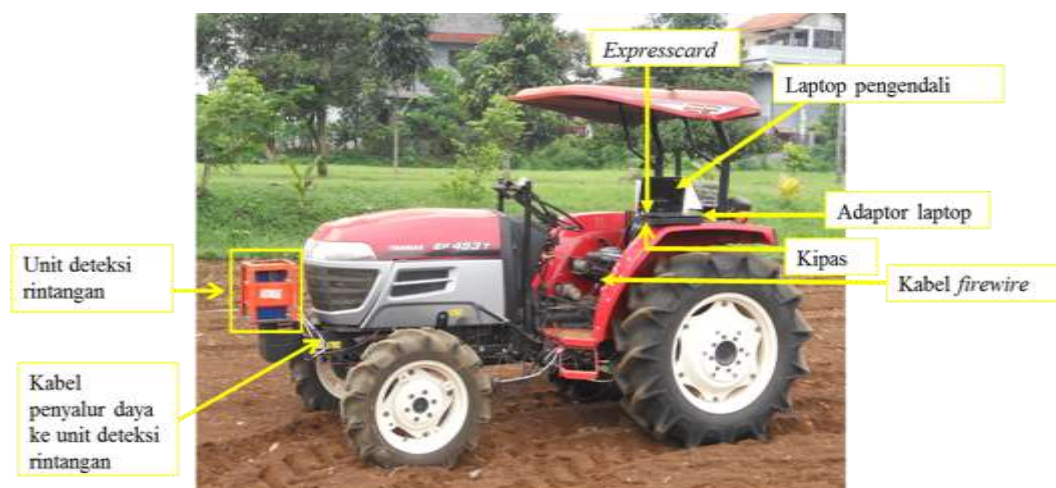
Gambar 6. Penempatan sistem deteksi rintangan pada traktor tanpa awak
