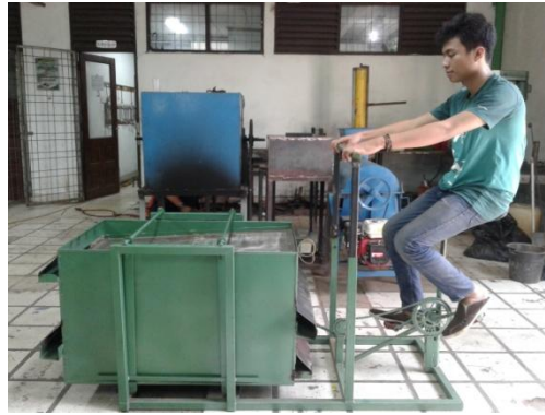
Gambar 7. Posisi Kerja Operator
