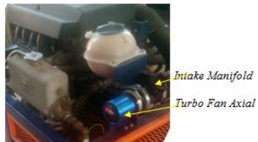
Gambar 4. Pemasangan Turbo Fan Aksial
