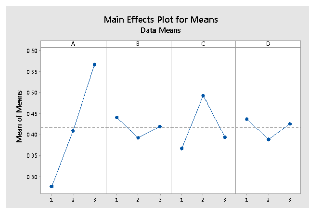
Gambar 7. Grafik Nilai Rata –rata MRPI pada Masing-masing Level dari Variabel Proses pulse current (A), on time (B), off time (C) dan Z down (D).
