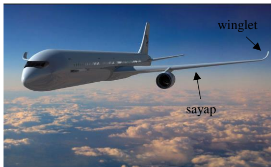
Gambar 3 Bentuk Blended Winglet Pesawat Terbang (Salahudin M. et.al, 2013)
