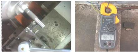
**Gambar 3.3** Proses Pemotongan dan Pengukuran Arus Listrik
