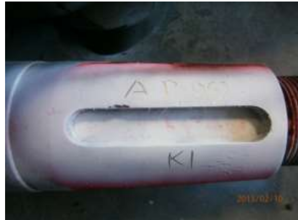
Gambar 4.1 Poros propeller kapal Anugrah Perdana 09 yang retak
