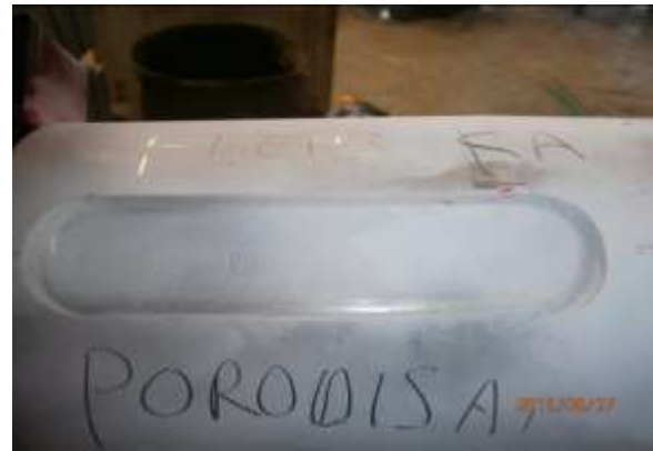
Gambar 4.4 Poros propeller yang terdapat retak
