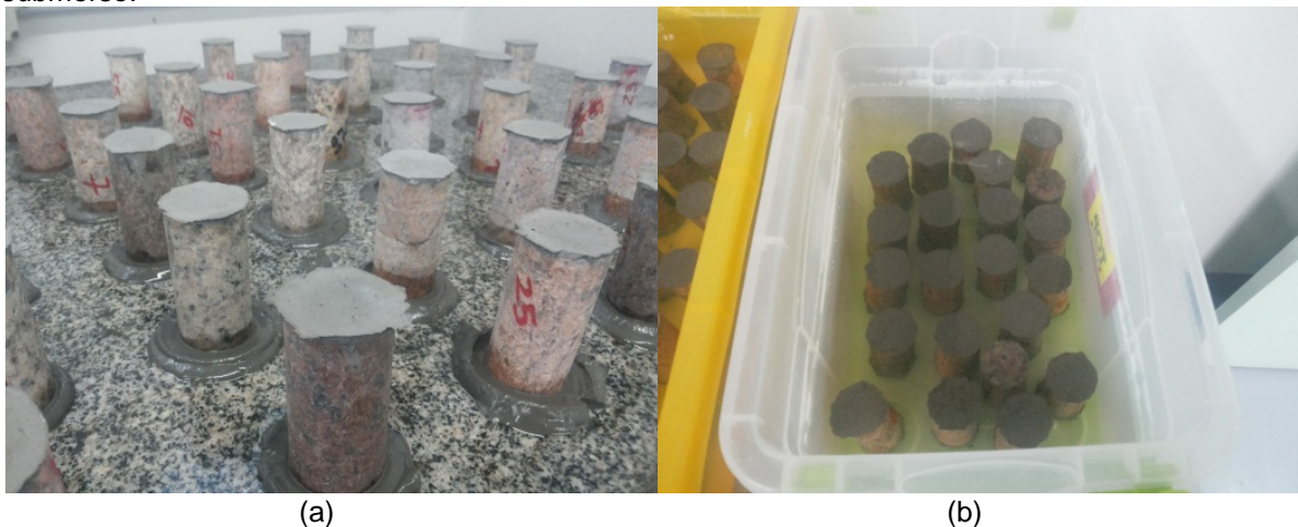
Figura 4 - Preparação dos testemunhos antes dos ensaios: a) Capeamento e b) testemunho submerso.
