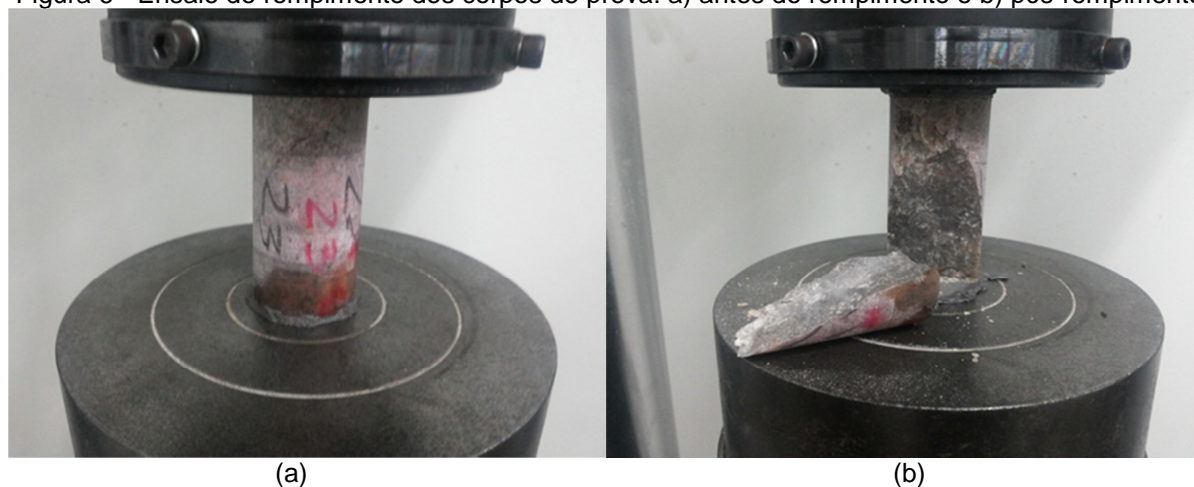
Figura 6 - Ensaio de rompimento dos corpos de prova: a) antes do rompimento e b) pós-rompimento
