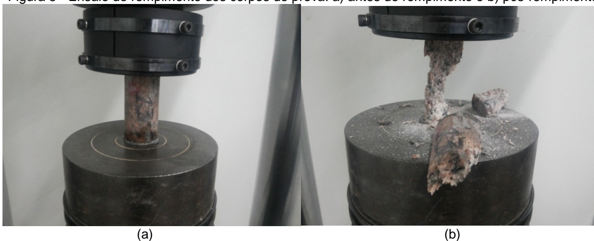
Figura 5 - Ensaio de rompimento dos corpos de prova: a) antes do rompimento e b) pós-rompimento
