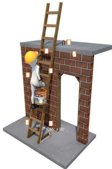
Figura 20 – Escada de uso de mão
