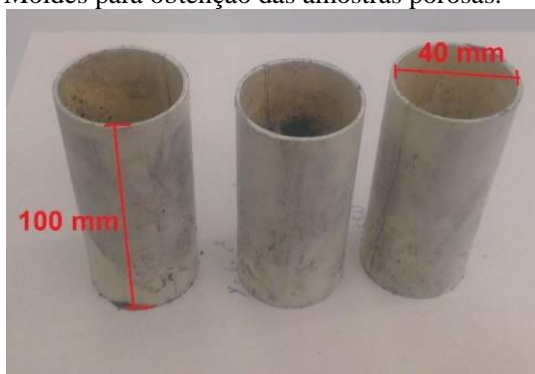
Figura 11 – Moldes para obtenção das amostras porosas.
