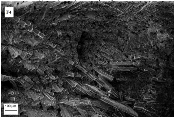
Figura 25 – Fractografia (MEV) da composição F4.
