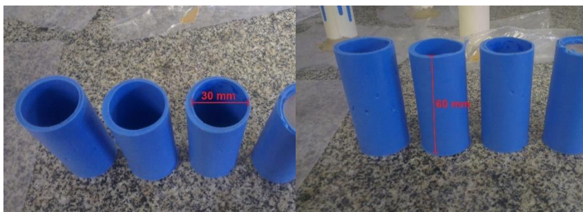
Figura 10 – Moldes em silicone para obtenção de corpos de prova.
