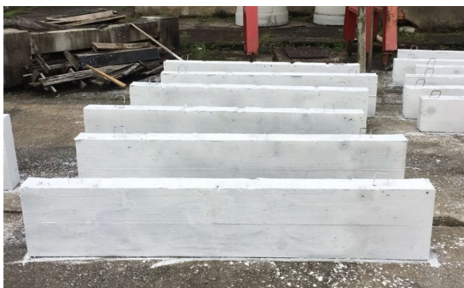
Figura 5. Vigas prontas e pintadas
