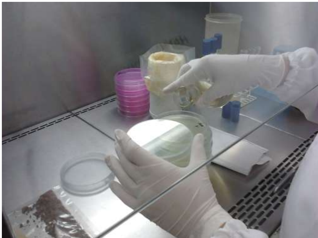
Figura 21- Ágar sendo vertido nas placas de Petri inoculadas com solução do solo.
