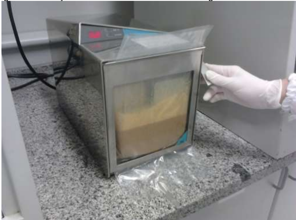
Figura 16- Solução da amostra de solo sendo homogeneizada.
