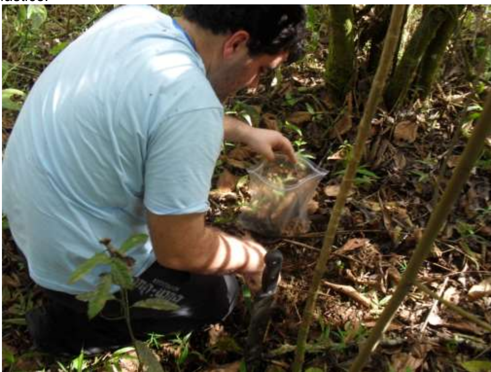
Figura 7- Amostras de solo sendo coletada e acondicionada em saco plástico.
