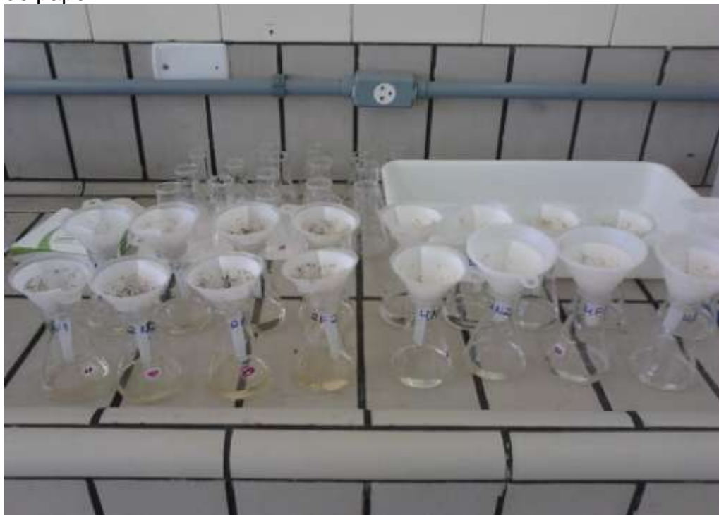
Figura 12- Soluções das amostras centrifugadas sendo filtradas em filtro de papel.
