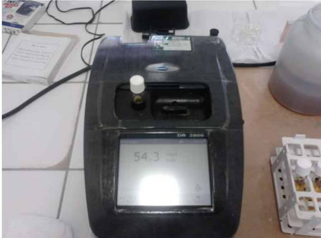
Figura 14- Solução da amostra no espectrofotômetro.
