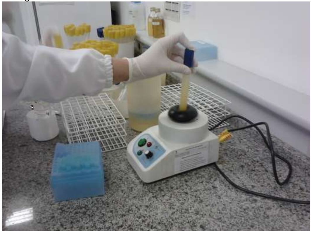
Figura 18- Tubo de ensaio com diluição da amostra sendo homogeneizado.
