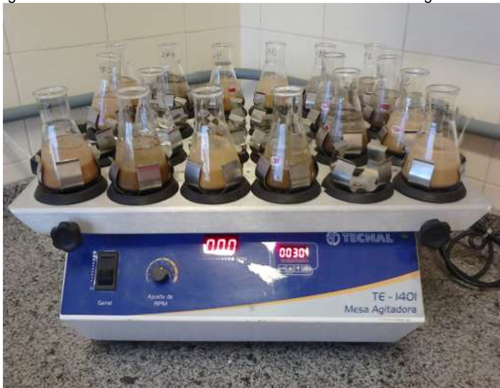
Figura 10- Amostras de solo e substancia extratora na mesa agitadora.
