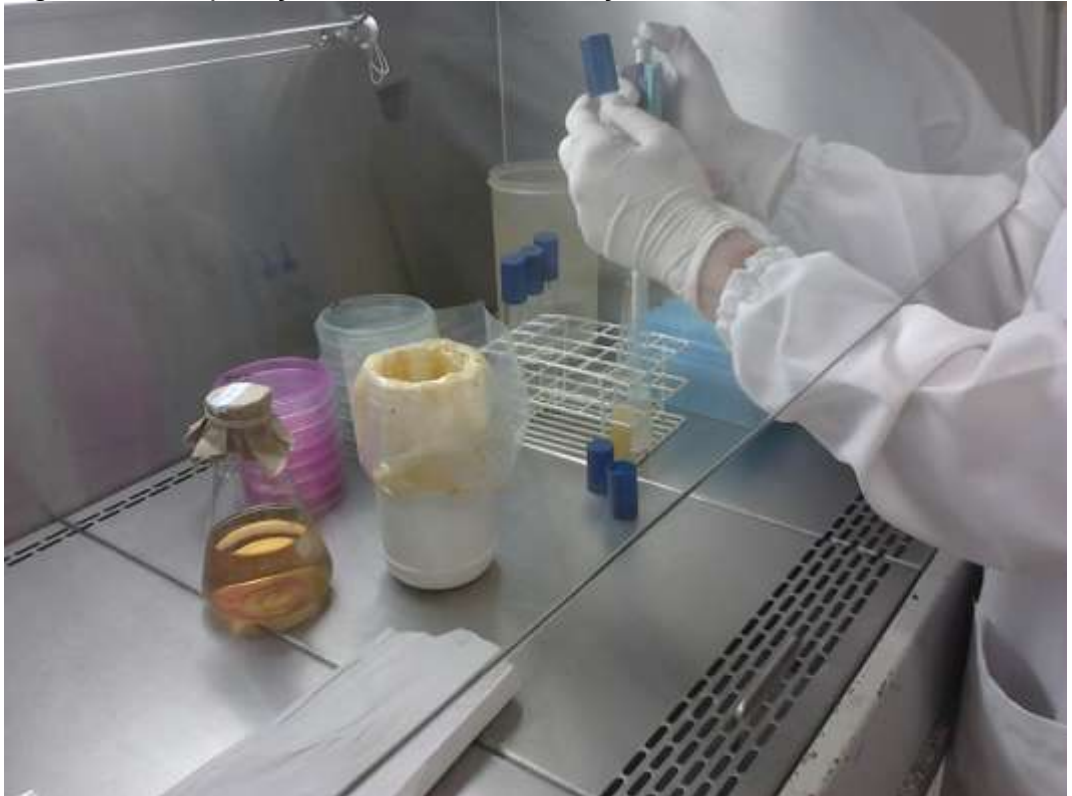
Figura 17- Preparação das diferentes diluições da amostra.
