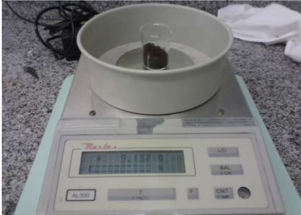
Figura 8- Subamostra de solo sendo pesada em balança de precisão.
