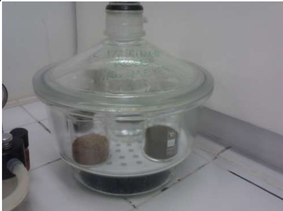
Figura 9- Dessecador contendo as subamostras de solo, clorofórmio e água destilada.
