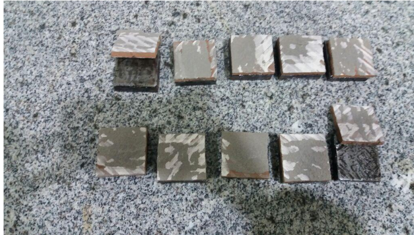
Figura 7 – Rupturas Argamassa aditivada 0,8%
