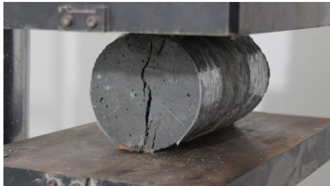
Figura 12 – Ruptura à tração por compressão diametral do corpo de prova
