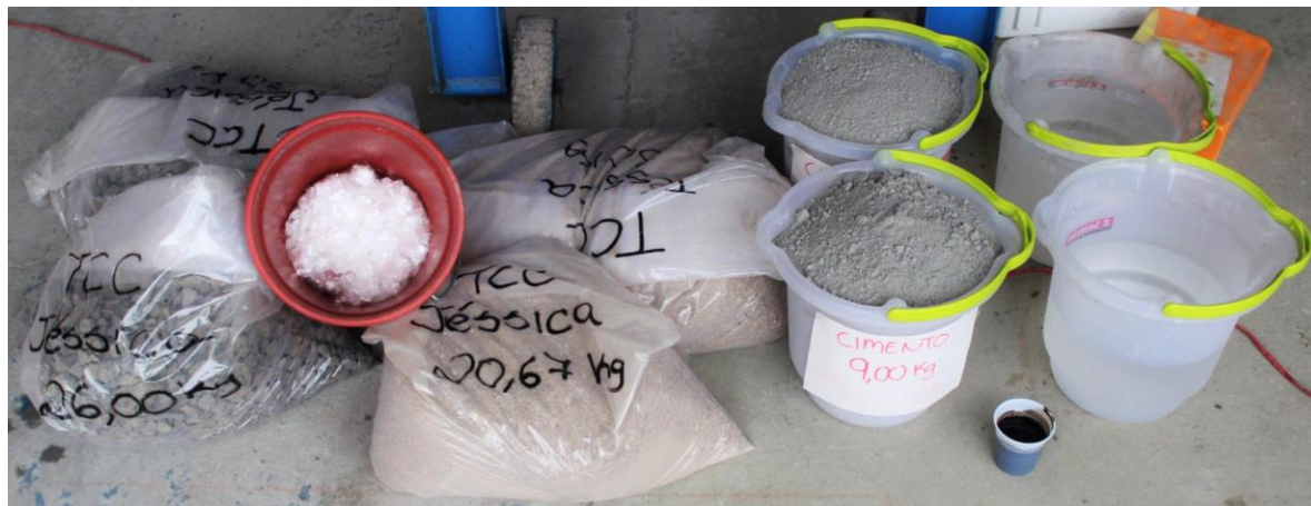
Figura 3 – Materiais utilizados para concretagem
