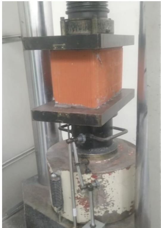
Figura 2: Determinação do módulo de deformação dos blocos cerâmicos
