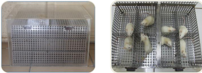
Figura 2 – Câmara de Inalação (40 cm de comprimento, 30 cm de largura e 25 cm de altura).
