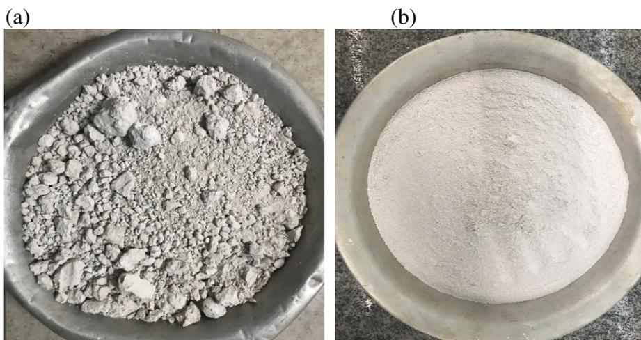
Figura 2. Resíduo do polimento de porcelanato: (a) aspecto natural, (b) seco e destorroado
