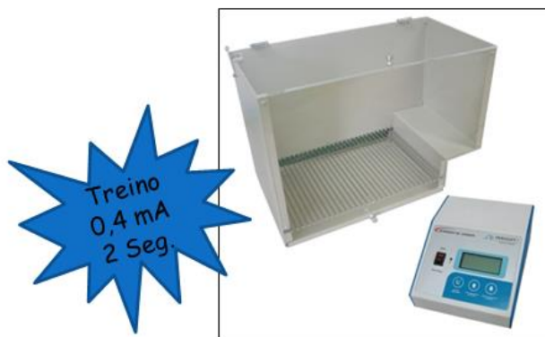
Figura 9: Representação do equipamento esQUIVA inibitória utilizado para avaliar os sintomas cognitivos relacionados a diferentes tipos de memória aversiva nos animais. Fonte: Desenho elaborado pela pesquisadora, 2017.
