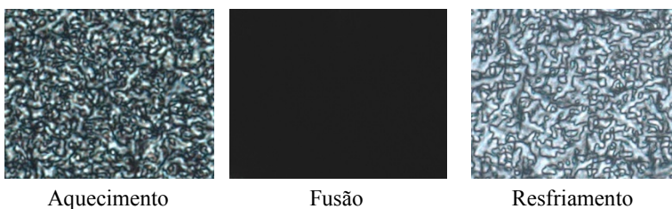
Figura 41 – Texturas em MOLP do CL exposto em câmara de radiação UV-A com refrigeração por 1000 horas.
