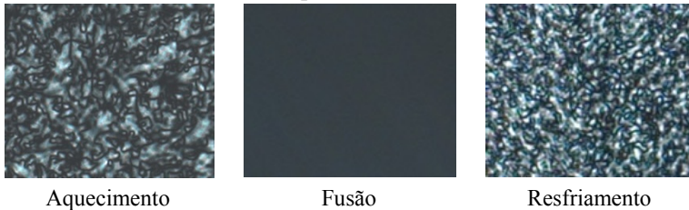
Figura 43 – Texturas em MOLP do CL exposto em câmara térmica sob 50 °C por 1000 horas.
