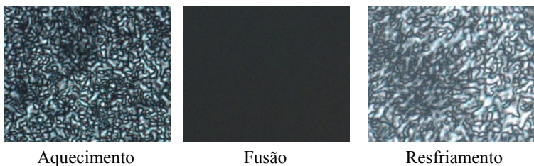
Figura 42 – Texturas em MOLP do CL exposto em câmara de radiação UV-A e UV-B sem refrigeração por 1000 horas.
