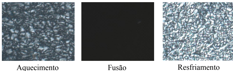
Figura 40 – Texturas em MOLP do CLT original.
