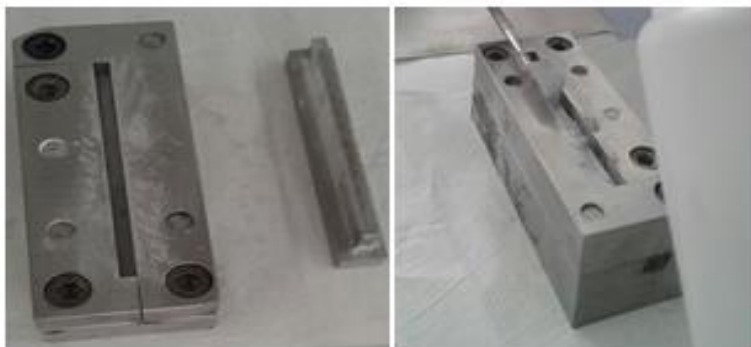
Figura 10 - Matriz metálica e preenchimento da matriz com o pó
