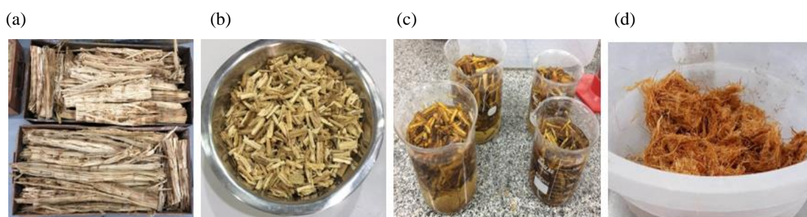
Figura 3. Processos para obtenção da fibra: (a) bagaço seco, (b) bagaço cortado, (c) bagaço antes da inserção em ácido, (d) e fibras vegetais após secas em estufa.
