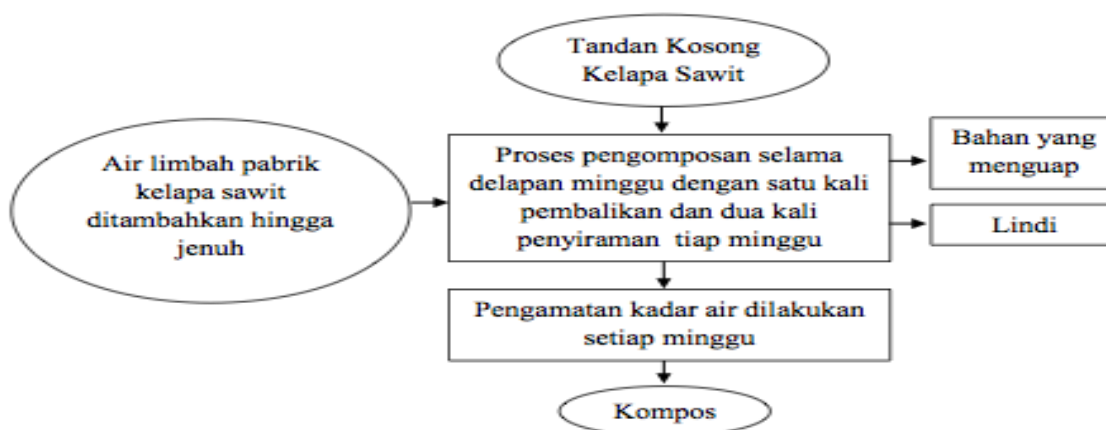
Gambar 1. Diagram alir proses pengomposan
