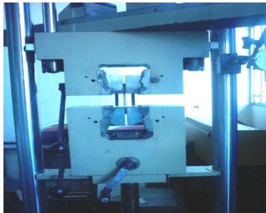
Gambar 2. Mesin uji Tarik Type Universal
