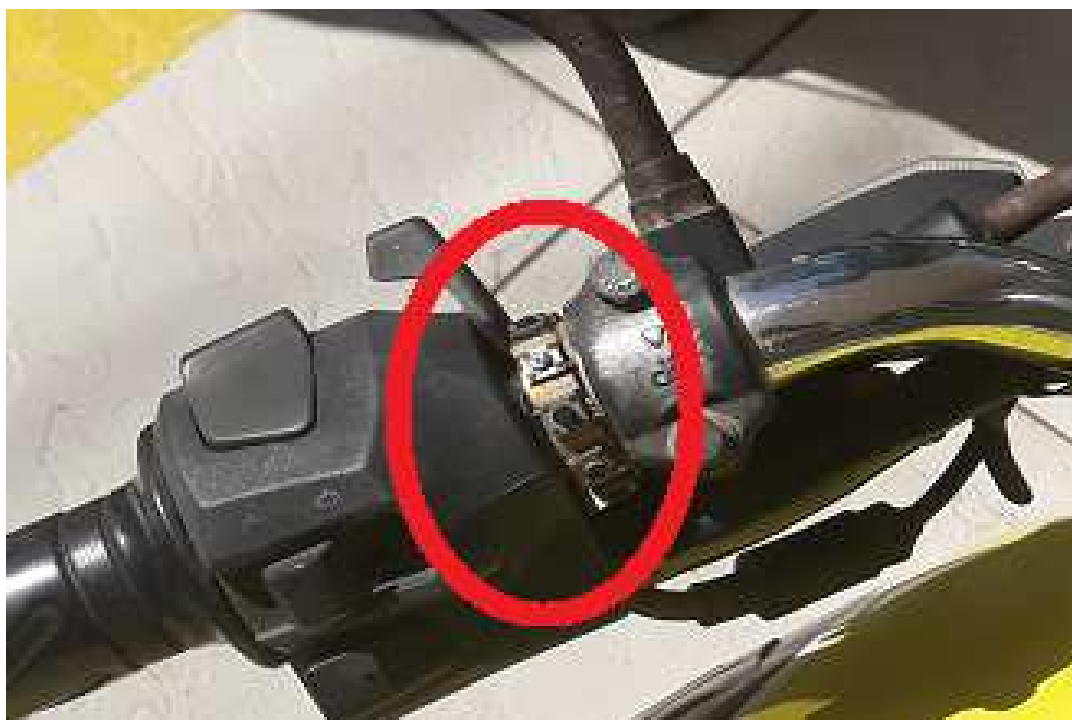
Figura 8 – Destaque abraçadeira esquerda do primeiro protótipo
