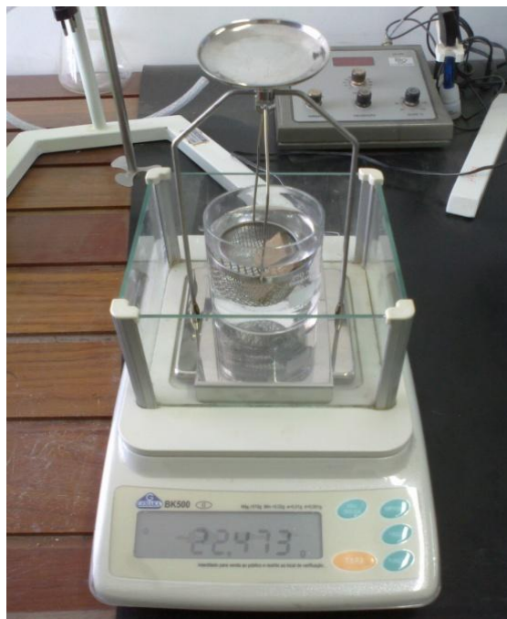
Figura 3.4 - Esquema para cálculo da densidade das ligas
