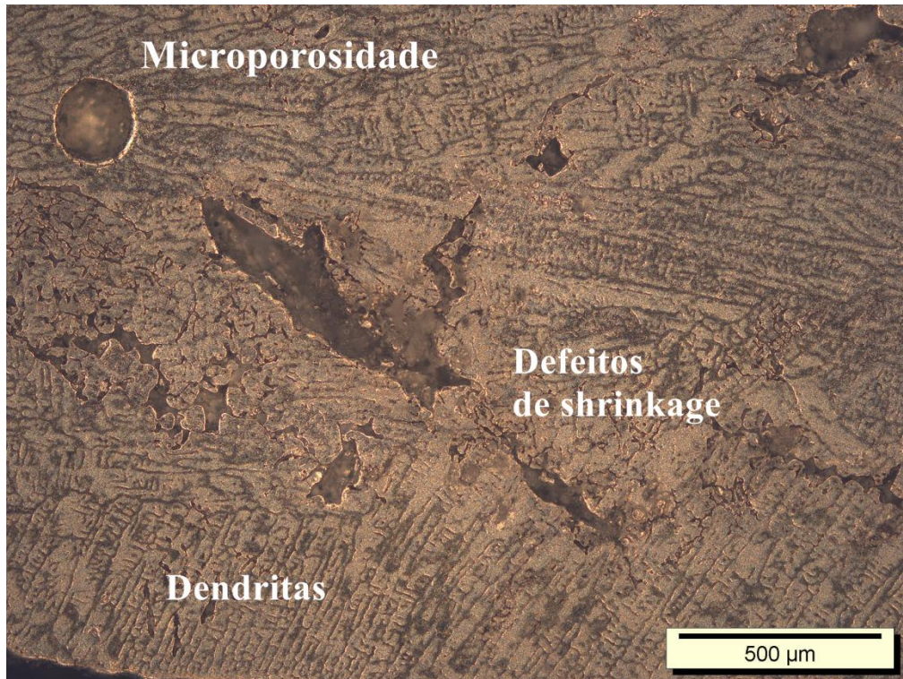
Figura 4.6– Principais defeitos de fundição presentes nas amostras A, B e C.
