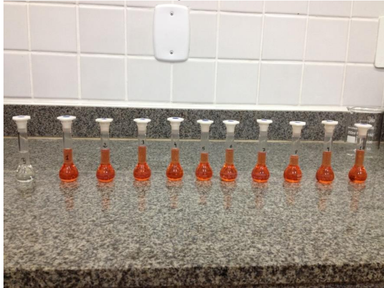
Figura 2: Composto de coloração alaranjada formado pela reação da sulfanilamida com os demais reagentes.
