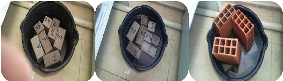
**Figura 36:** Processo de imersão dos CP na água
