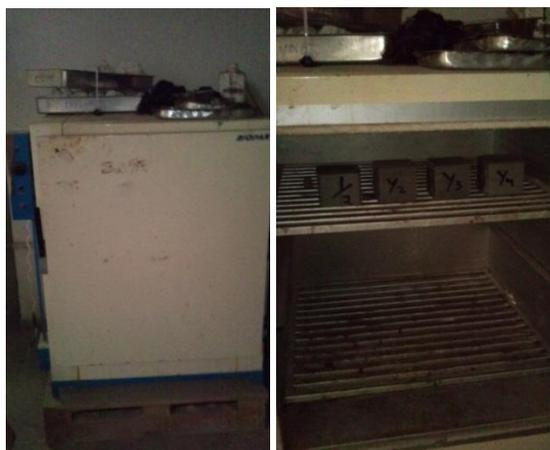
**Figura 48:** Estufa de esterilização e secagem com termômetro para aferição
