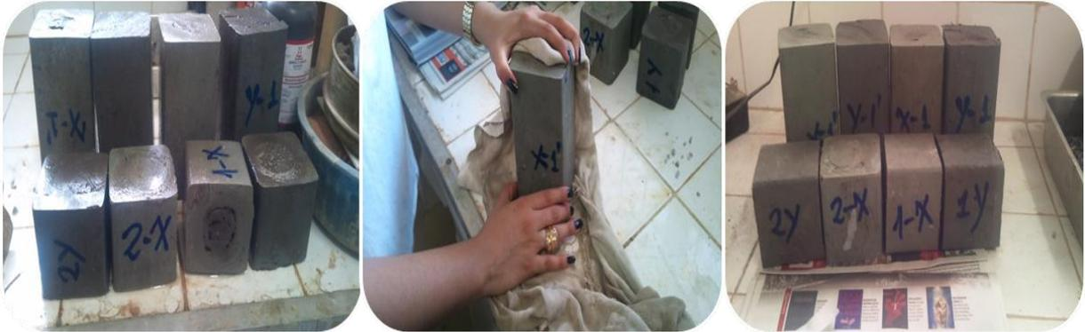
**Figura 37:** Processo de pesagem dos CP saturados
