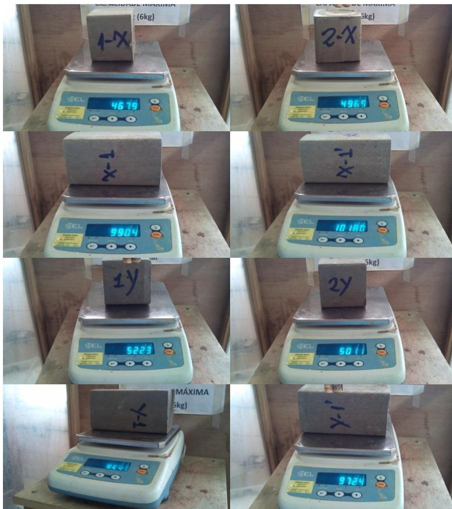
**Figura 53:** Corpos-de-prova usados no ensaio de Absorção
