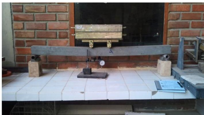
**Figura 46:** Ensaio de Fluência
