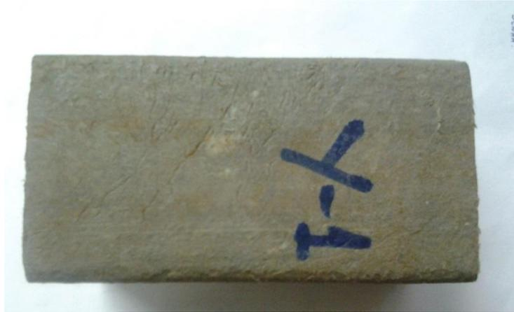
**Figura 59:** Frechal após ensaio de resistência ao apoio
