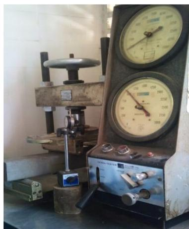
**Figura 40:** Ensaio de Flexão
