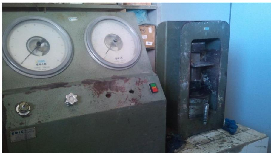
**Figura 42:** Prensa universal 2 para ensaio de compressão
