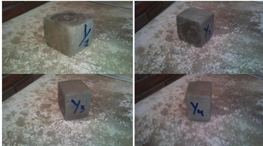
**Figura 57:** Corpos-de-prova rompidos
