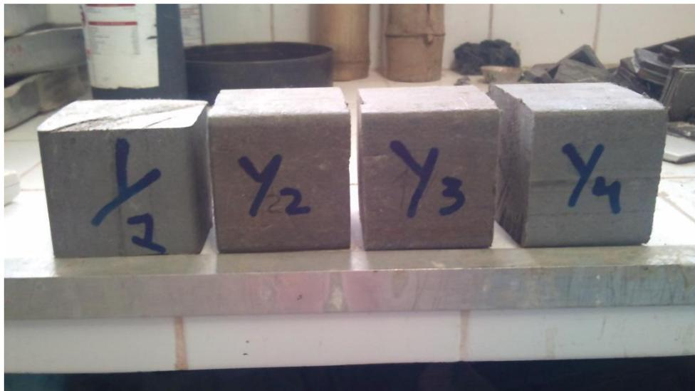
**Figura 47:** Corpos-de-prova para ensaio de compressão à temperatura
