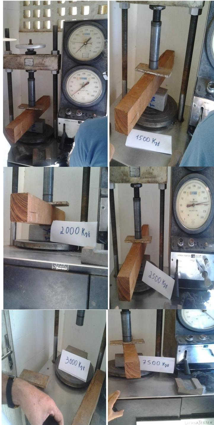
**Figura 58:** Ensaio de resistência ao apoio
