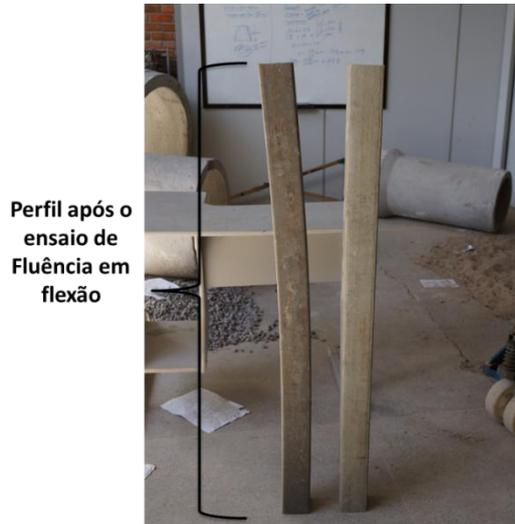
**Figura 56:** Frechal no ensaio de fluência
