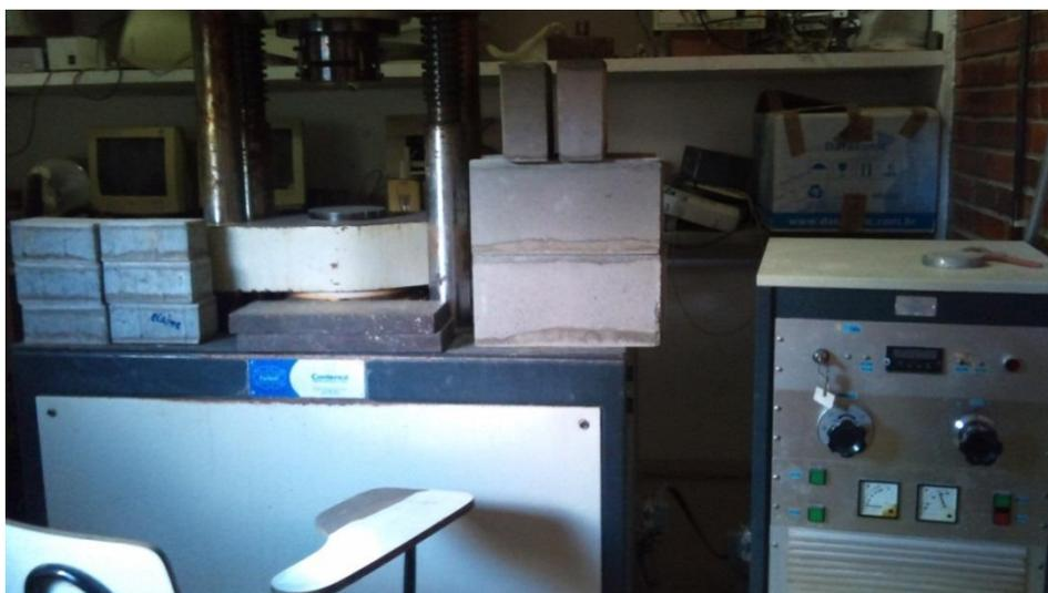
**Figura 41:** Prensa universal 1 para ensaio de compressão
