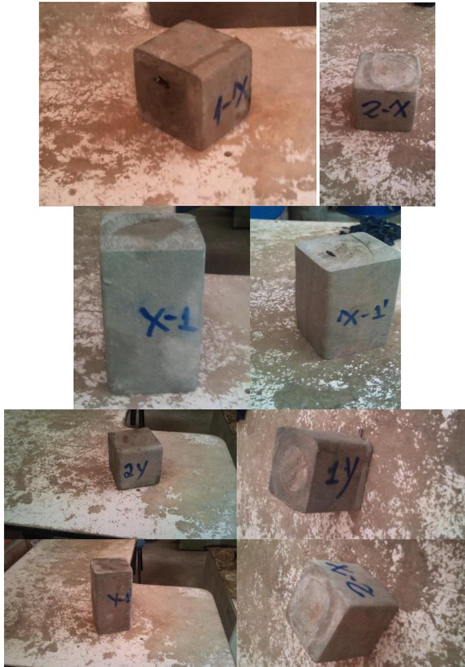
**Figura 55:** Corpos-de-prova rompidos após o ensaio de compressão
