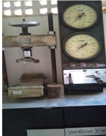
**Figura 38:** Máquina para ensaio de resistência à flexão
