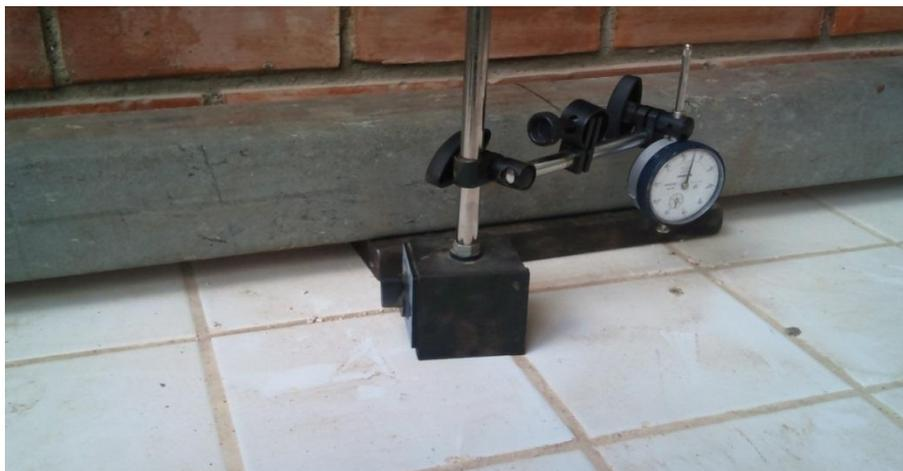
**Figura 44:** Extensômetro usado no ensaio de fluência
