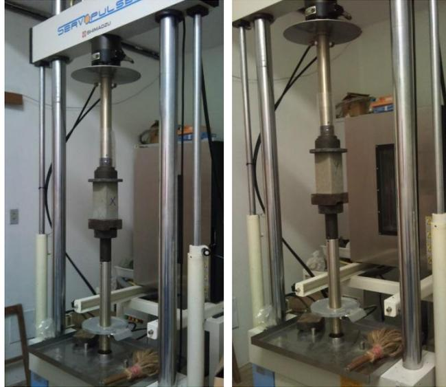
**Figura 60:** Ensaio para determinação do módulo de elasticidade em compressão
