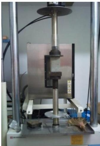
**Figura 52:** Ensaio modelo de elasticidade no CP
