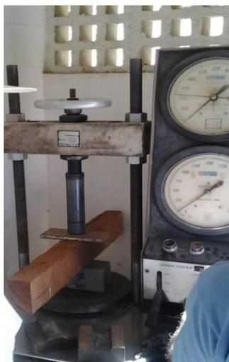
**Figura 49:** Ensaio de resistência ao apoio
