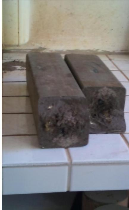
**Figura 54:** Corpo-de-prova rompido
