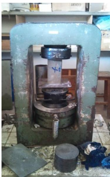
**Figura 43:** Ensaio de resistência à compressão
