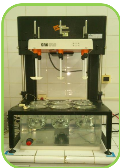
FIGURA 03- Aparelho Dissolutor Hanson Research, modelo SR6.
