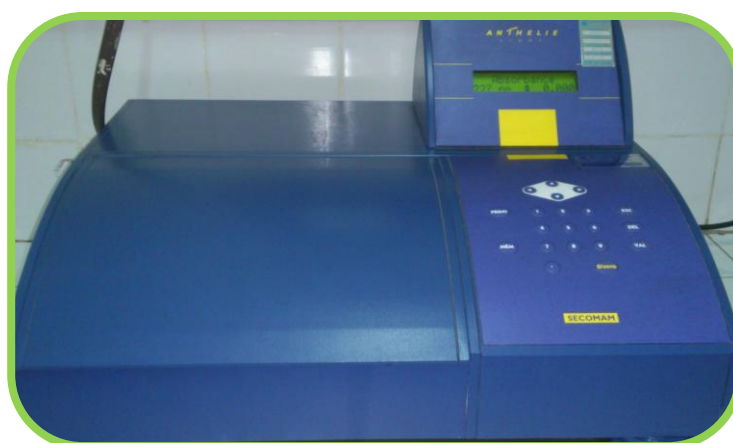
FIGURA 04- Equipamento Espectrofotômetro UV/VIS SECOMAN, Anthelie Light.
