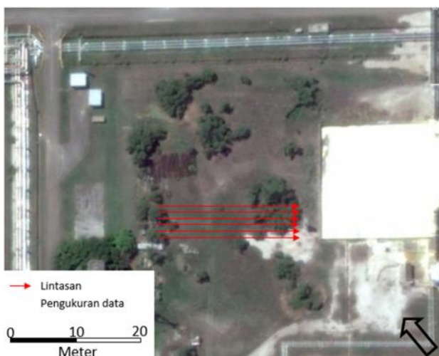
Gambar 2 Layout pengukuran data. Garis warna merah menunjukkan 6 lintasan pengukuran data.
