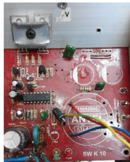
Gambar 5 Hasil perancangan rangkaian inverter pengubah arus DC menjadi AC.
