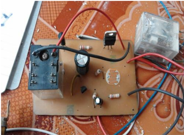
Gambar 3 Hasil perancangan rangkaian sensor cahaya.
