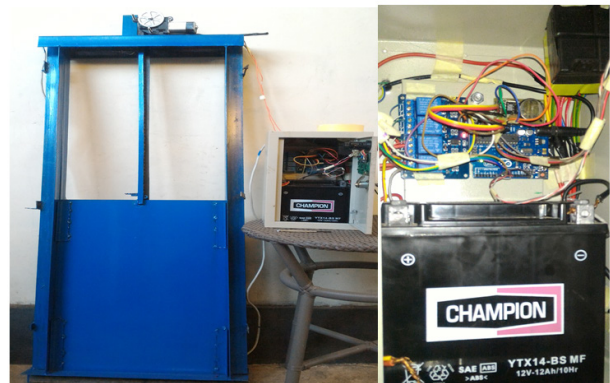
Gambar 3. Implementasi sistem kontrol pintu air irigasi berbasis Arduino
