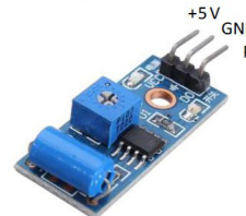
c. Sensor getar SW420 ke pin 6
